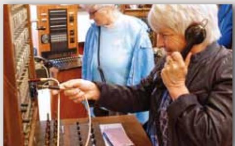
So ist das: Wenn die Klappe fällt, wird in die passende Buchse gestöpselt und der Anrufer nach dem gewünschten Teilnehmer abgefragt. Dann mit dem zweiten Stöpsel die Gegensprechstelle verbinden und den Rufknopf drücken. Das ist Handvermittlung. Sie können das auch.
