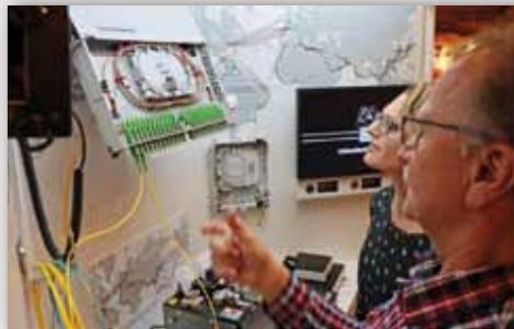
Mit dem Lasertester finden wir ein Leck im Glasfaserkabel. Spleiss-Stellen werden mit dem Mikroskop kontrolliert und eine Spezialsonde lokalisiert aller kleinste Schmutzpartikel.
