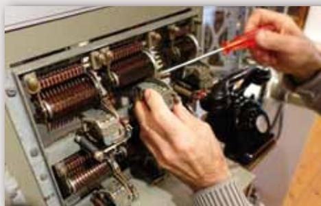
Der Kontaktsatz mit den vielen rotierenden Schleifern ist im Betrieb anspruchsvoll und wartungsintensiv. Für die Instandhaltung der mechanischen Gruppen sind Erfahrung und eine ruhige Hand unverzichtbar.
